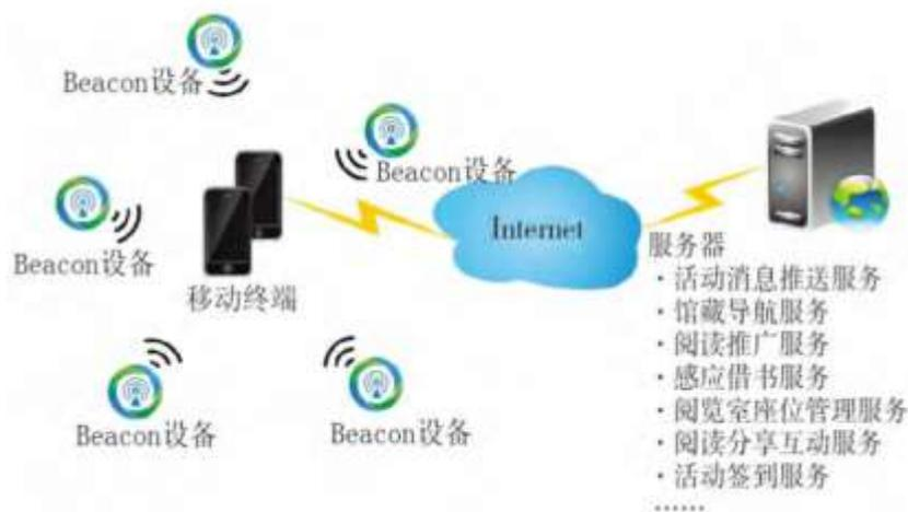
图 1 Beacon 定位服务系统构成图
